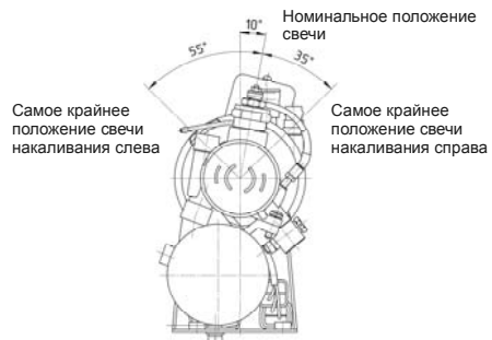
Рисунок 9 - Допустимое положение горелки по свече накаливания
